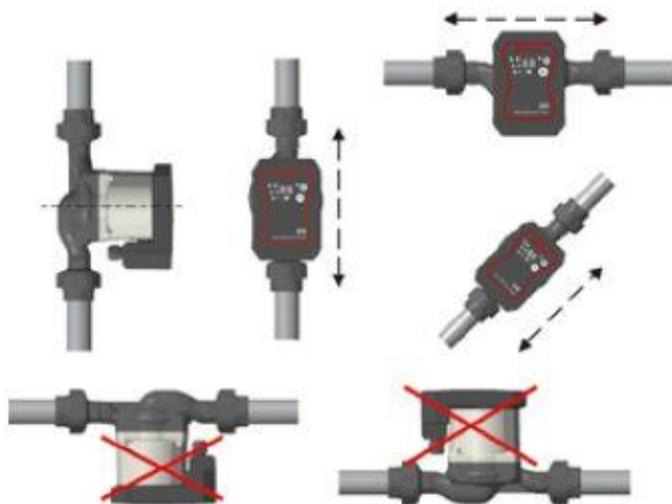
Рис. 6. Допустимые и недопустимые варианты монтажа насоса.
