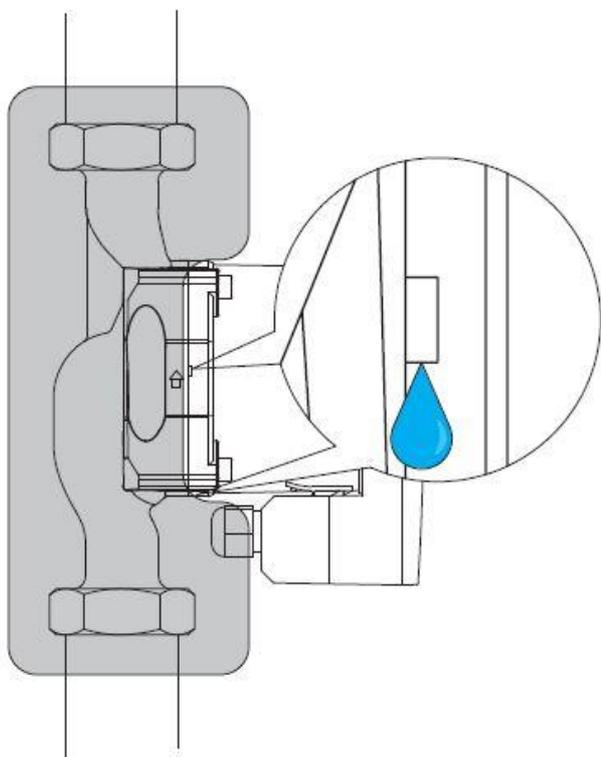
Рис. 8. Теплоизоляция насоса
