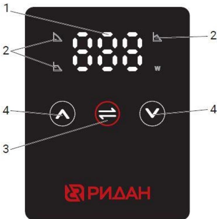
Рис. 4. Панель управления насосом RWE 32-120S.
