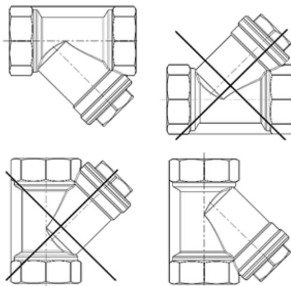
Используемый присоединительный фитинг должен обеспечивать надежную и герметичную установку фильтра с возможностью его демонтажа.
