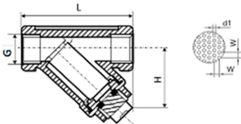
Габаритные размеры фильтров сетчатых типа FVS-R
