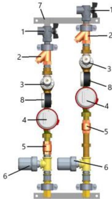
1. Кран шаровой угловой для подключения к стоякам водоснабжения здания Ду 15
