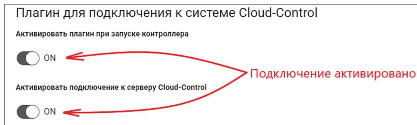
Кроме подключения к стандартному серверу системы, присутствует возможность задания пользовательского подключения. Для этого требуется активировать соответствующий переключатель, ввести адрес сервера и имя пользователя/пароль для подключения к брокеру обработки сообщений:
