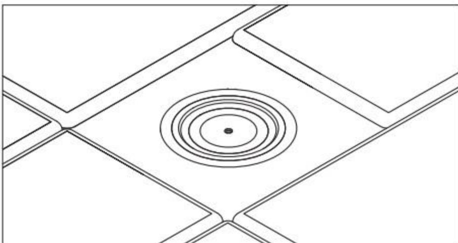
Перед началом эксплуатации системы демонтируйте монтажную пластину и очистите поверхность датчика.
