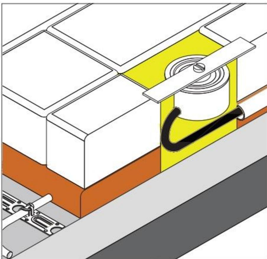
Монтаж датчика грунта выполняется совместно с монтажом нагревательного кабеля. Для этого в месте монтажа датчика необходимо предусмотреть углубление 100x100x130 мм, к которому необходимо подвести трубку с протяжкой Ø16 мм для монтажа кабеля датчика.
