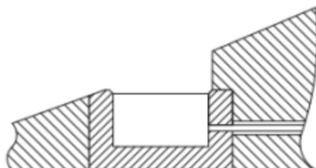
На наклонных поверхностях датчик должен быть установлен горизонтально
