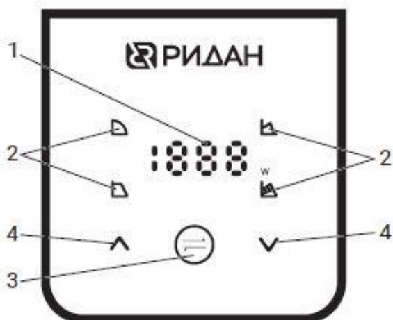
Рис. 5. Панель управления насосом RWE 40...80-XXX.
