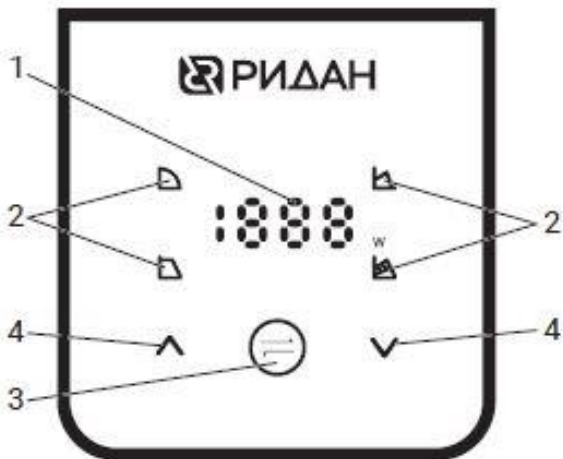
Рис. 5. Панель управления насосом RWE 40...80-XXX.
