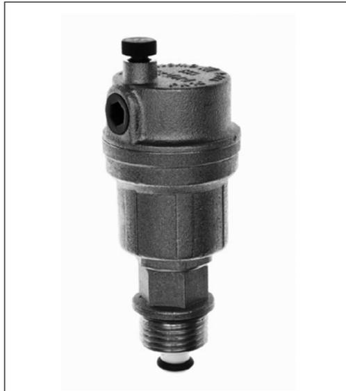
Автоматический воздухоотводчик предназначен для отведения воздушных скоплений из трубопроводов и воздухоотборников внутренних систем теплоснабжения зданий (систем отопления, теплоснабжения вентиляционных установок, кондиционеров, коллекторов и др.).
