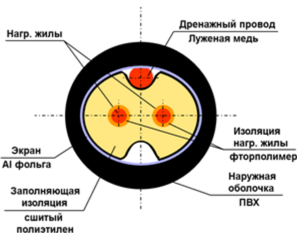
Рис. 2. Устройство нагревательного кабеля ДЕВИ Snow-30T
