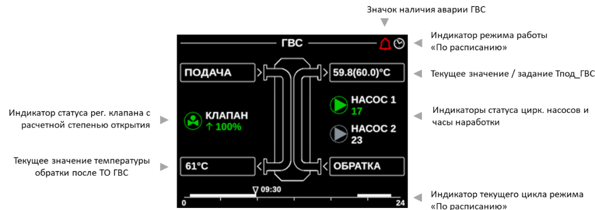
Рис.11. Мнемосхема модуля ГВС.
