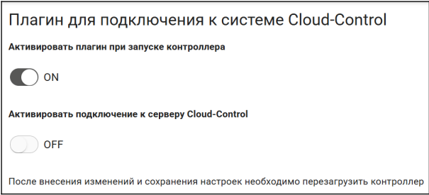
Рис.19. Плагин подключения ECL4 к Cloud-Control в разделе Расширения на веб-сервере ECL4.
