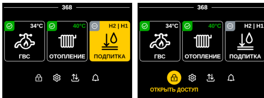
Рис.6. Главный экран ECL4 Control с активной навигацией в области модулей автоматики (слева) и в области общих меню (справа).
