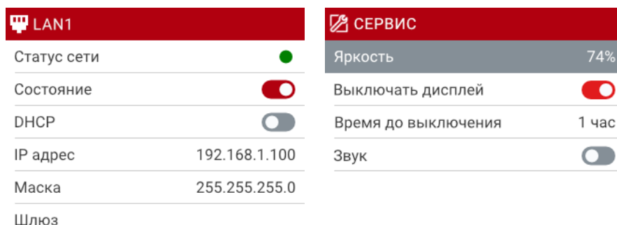
Рис.4. Примеры экранов служебного меню раздела «Диспетчеризация/Ethernet» и «Сервис».
