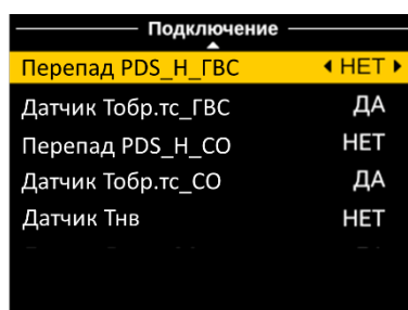
Рис.25. Меню Подключение опциональных датчиков в разделе Общие настройки (⚙️) на дисплее контроллера.
