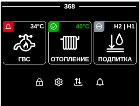
Рис.7. Пример отображения трех модулей автоматики с разными статусами – в аварии, в работе и остановлен.
