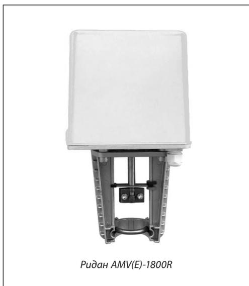
Электропривод предназначен для управления регулирующими клапанами VFM-2R DN65–80, VF-3R DN65–80, VFS-2R DN15–80 и VF-2R DN65–80. Управление приводом Ридан AMV-1800R осуществляется по импульсному сигналу от трехпозиционных электронных регуляторов Ридан ECL-3R/4R или подобных. Привод Ридан AME-1800R управляется аналоговым сигналом.
