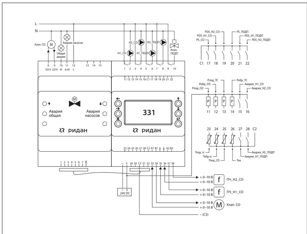
**Конфигурация входов/ выходов ECL-3R 331 FC и дополнительного модуля ECL-3R Triac**
