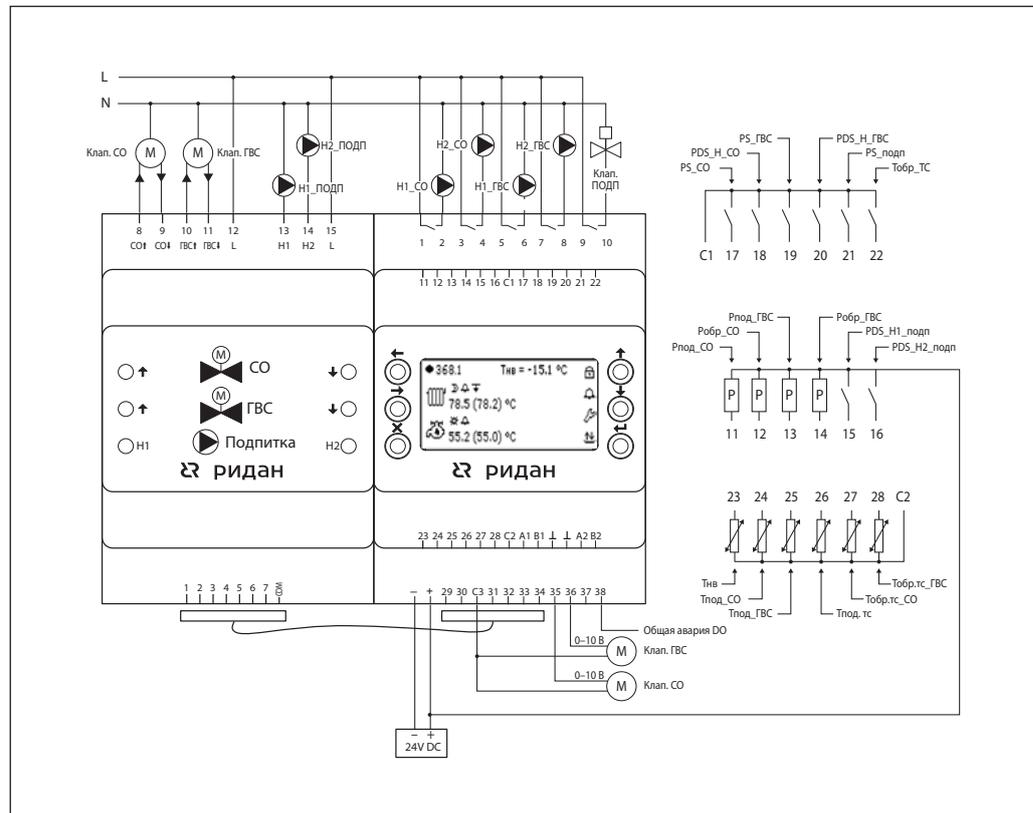
**Конфигурация входов/ выходов ECL-3R 368 и дополнительного модуля ECL-3R Triac** (для версии контроллера 1.18 конфигурация 1)
