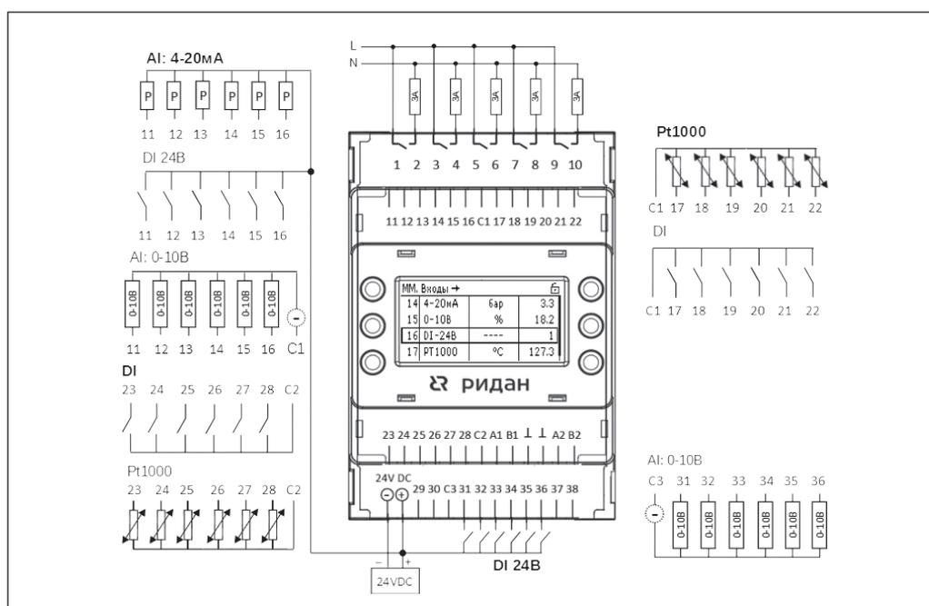
**Схема подключения датчика Pt1000**
