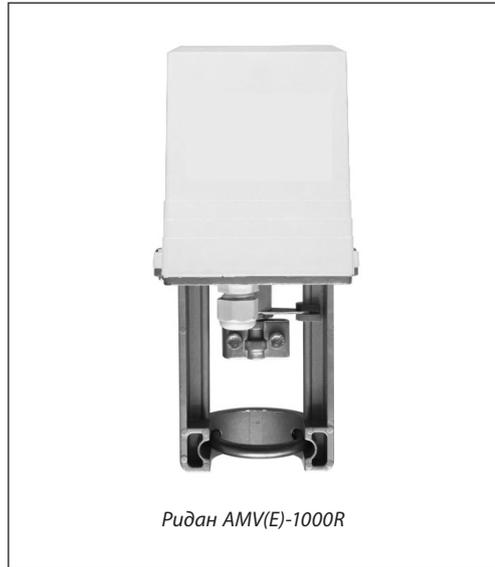
Электропривод предназначен для управления регулирующими клапанами VRB-2R/3R DN 15–50 и AQT-R DN 40–50. Управление приводом Ридан AMV-1000R осуществляется по импульсному сигналу от трехпозиционных электронных регуляторов Ридан ECL-3R/4R или подобных. Приводы Ридан AME-1000R управляются аналоговым сигналом.
