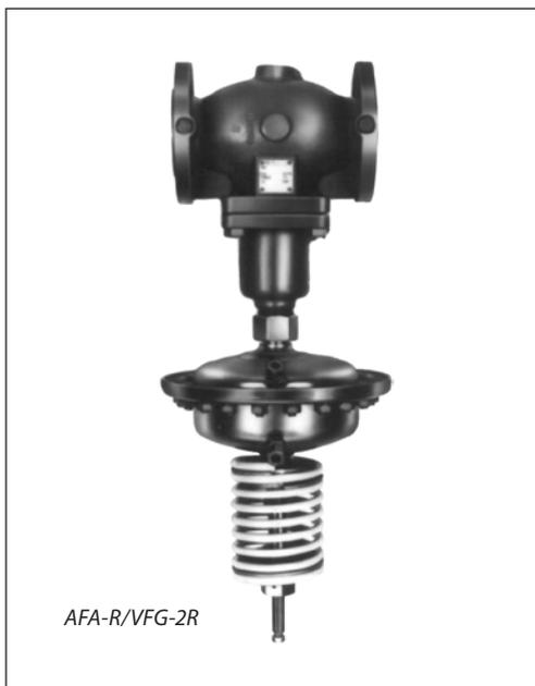
AFA-R/VFG-2R — автоматический регулятор Ридан, поддерживающий постоянное давление в трубопроводе до регулятора (по ходу движения теплоносителя). Предназначен для применения в системах централизованного теплоснабжения. При повышении давления до регулятора клапан открывается.
