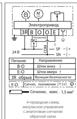
**Схема электрических соединений (продолжение)**
