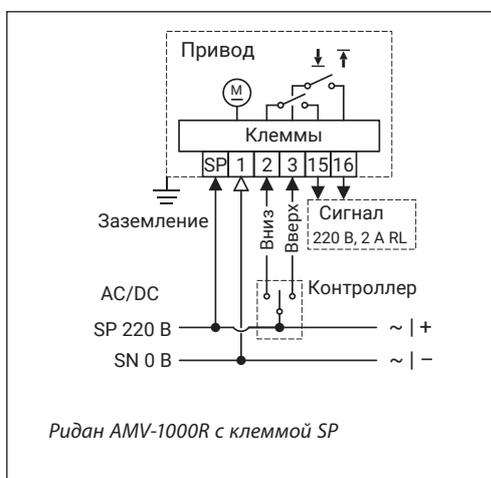
**Электрическая схема AMV-1000R 220В с клеммой SP**
