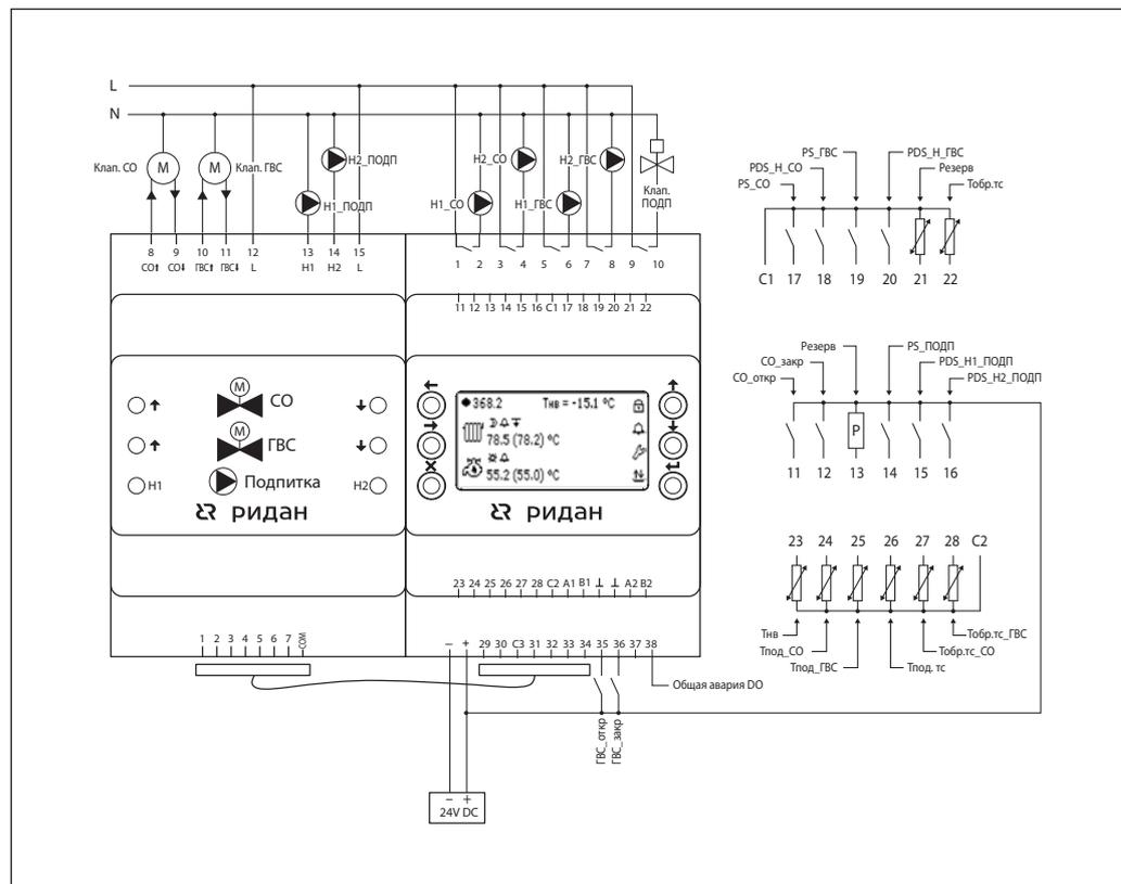
**Конфигурация входов/ выходов ECL-3R 368 и дополнительного модуля ECL-3R Triac** (для версии контроллера 1.18 конфигурация 2)
