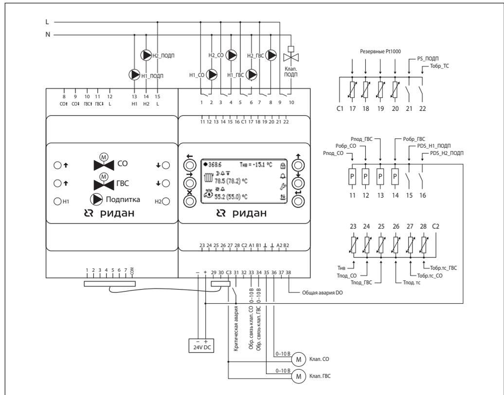
**Конфигурация входов/ выходов ECL-3R 368 и дополнительного модуля ECL-3R Triac** (для версии контроллера 1.18 конфигурация б)
