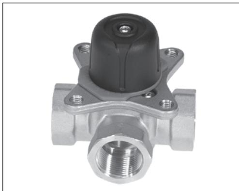
Клапан регулирующий поворотный серии HRB-3R предназначен для применения в системах теплоснабжения, где допускается некоторая протечка теплоносителя через закрытый клапан и нет необходимости в обеспечении точных характеристик регулирования.
