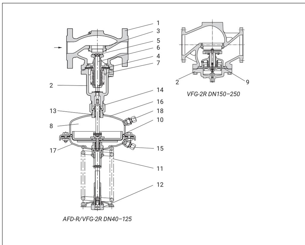
Если система находится в нерабочем состоянии, то клапан полностью открыт. Давление в системе после регулирующего клапана передается в полость под регулируемую диафрагму (со стороны настроечной пружины) через импульсную трубку. На другую сторону диафрагмы действует атмосферное давление.
