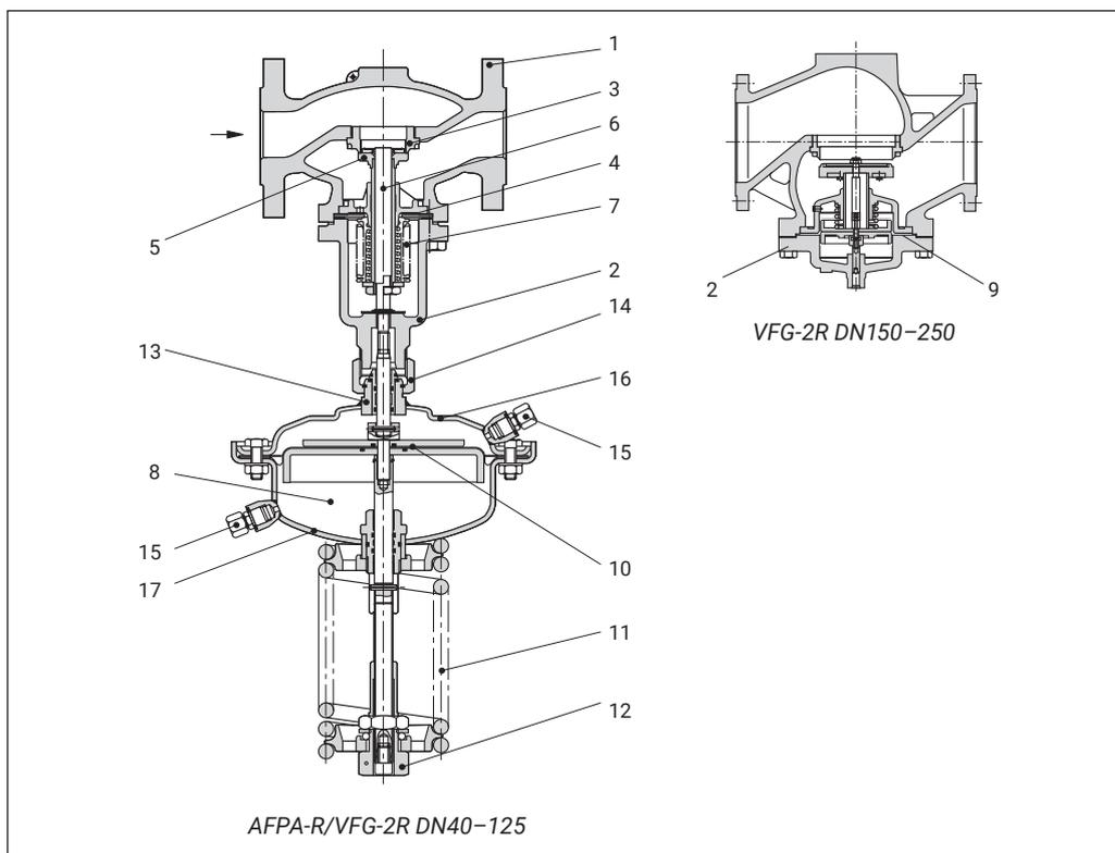
Давление в трубопроводе до и после регулятора передается в камеры над и под мембраной через импульсные трубки. При возрастании перепада давления свыше установленного значения клапан начинает открываться до тех пор,
