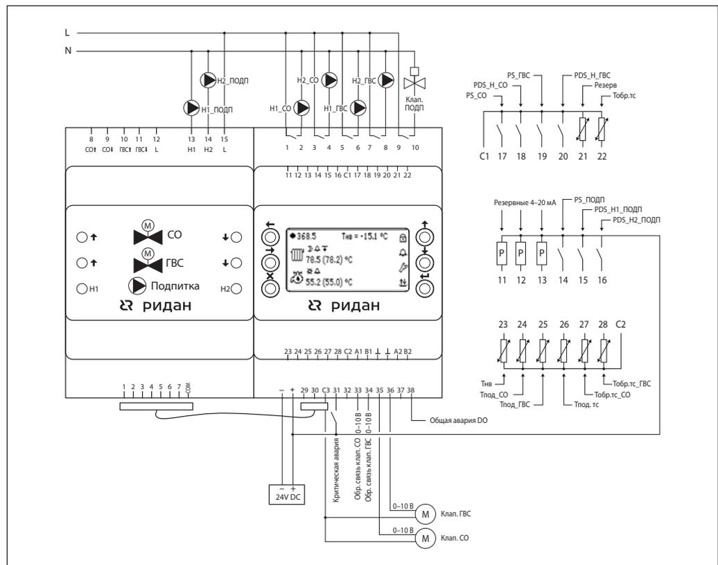
**Конфигурация входов/ выходов ECL-3R 368 и дополнительного модуля ECL-3R Triac** (для версии контроллера 1.18 конфигурация 5)
