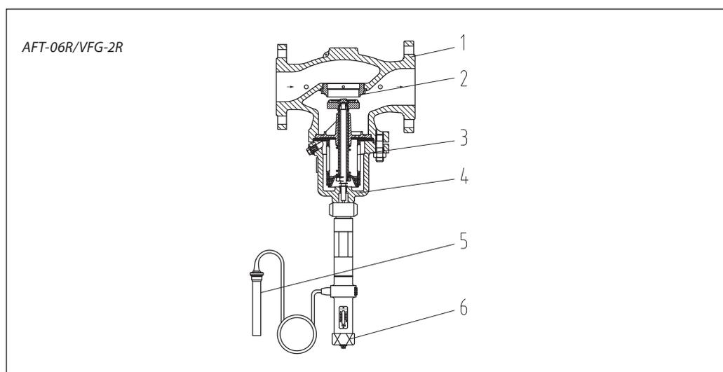
Изменение температуры рабочей среды внутри датчика изменяет ее объем и давление, которое передается по капиллярной трубке на пружину термоэлемента. Пружина, сжимаясь
