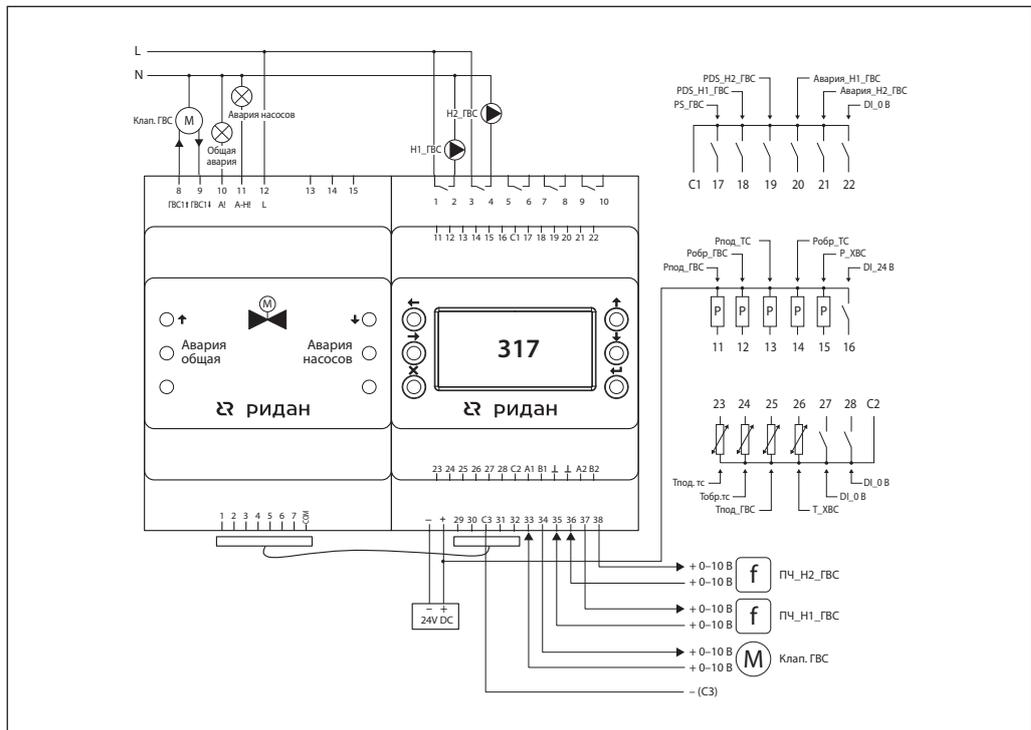
**Конфигурация входов/ выходов ECL-3R 317 FC и дополнительного модуля ECL-3R Triac**
