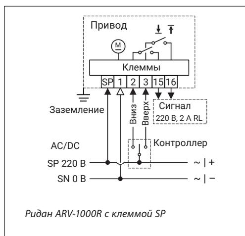
**Электрическая схема ARV-1000R 220 В с клеммой SP**
