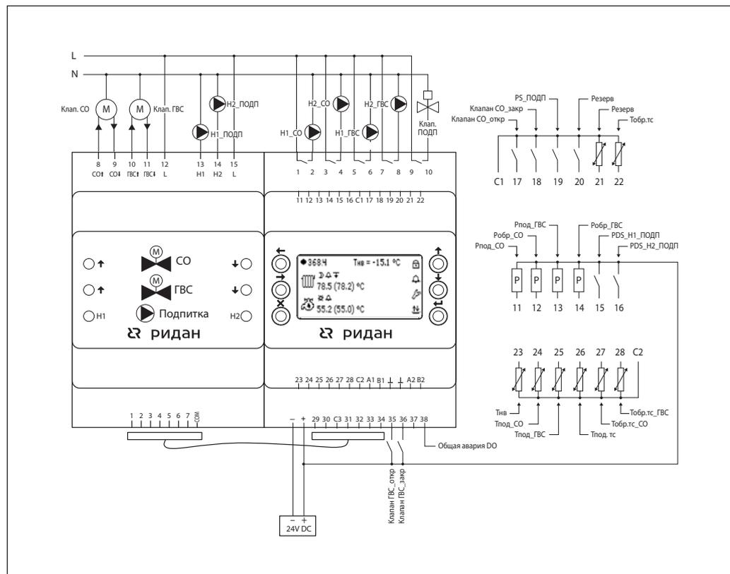
**Конфигурация входов/ выходов ECL-3R 368 и дополнительного модуля ECL-3R Triac** (для версии контроллера 1.18 конфигурация 4)
