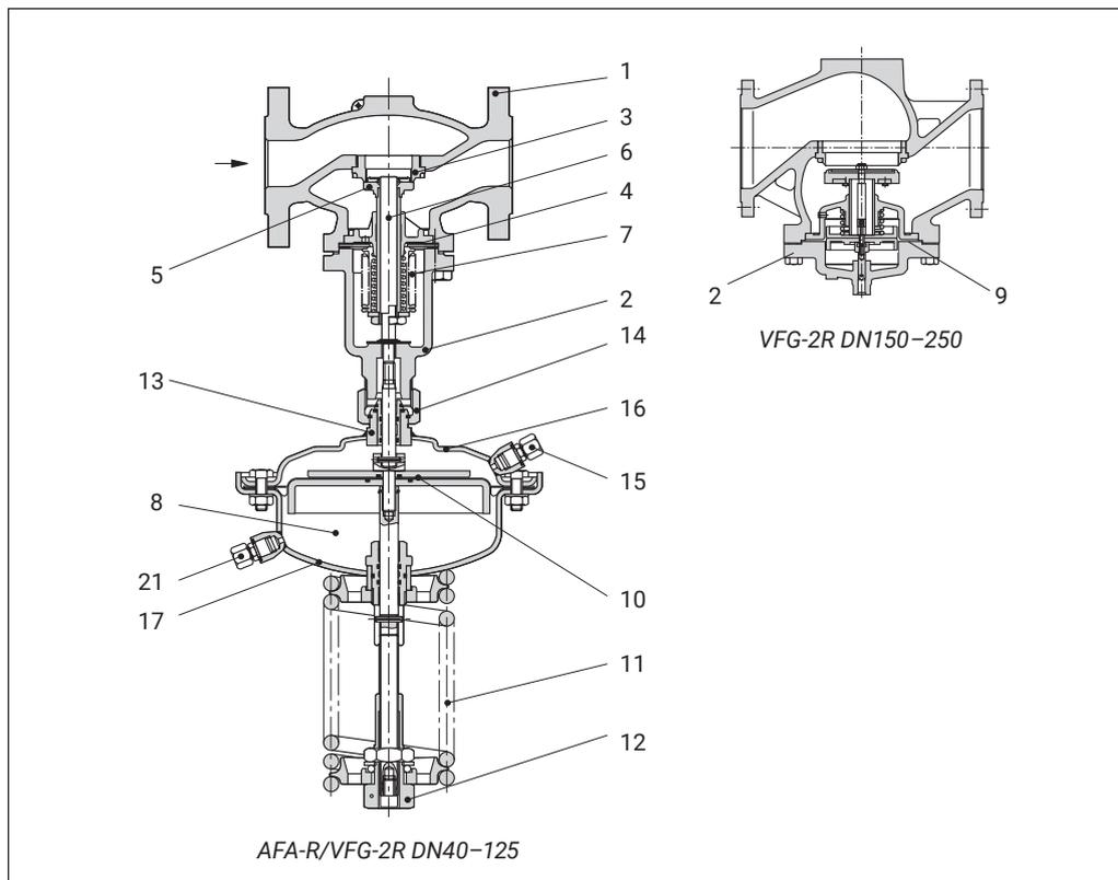
Если система находится в нерабочем состоянии, то клапан полностью закрыт. Давление в трубопроводе перед регулирующим клапаном передается в полость над регулирующей диафрагмой через импульсную трубку. На другую сторону диафрагмы действует атмосферное давление.
