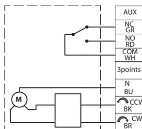
**Импульсный 3-поз. + выключатель<sup>1</sup>**
