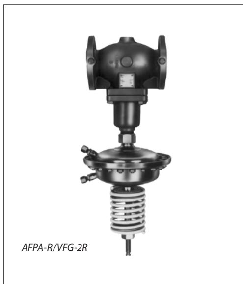
AFPA-R/VFG-2R является автоматическим регулятором «перепуска» Ридан для использования в системах централизованного теплоснабжения. При повышении перепада давления на регуляторе клапан открывается.
