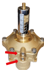
Рис. 6. Выпуск воздуха из мембранного блока АРТ-R (с помощью шестигранного ключа 3 мм)
