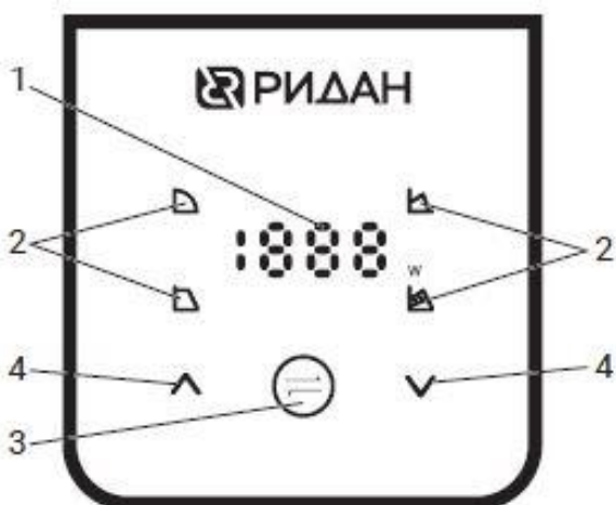
Рис. 5. Панель управления насосом RWE 40...80-XXX.
