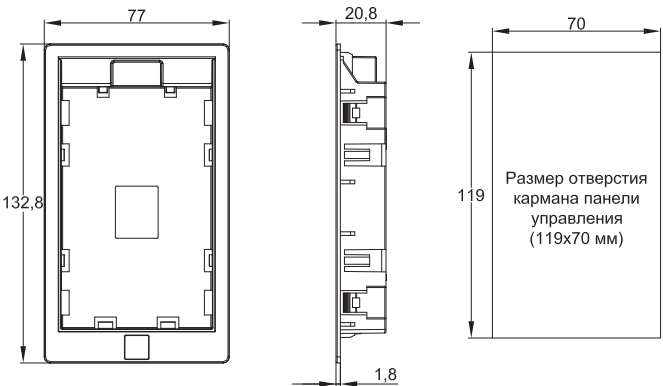
Рисунок 3.7-2 – Габаритные размеры держателя внешней цифровой двухстрочной панели управления (единица измерения – мм)
