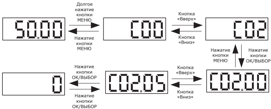
Рисунок 5.5-3 – Основные операции с панелью управления
