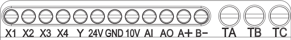
Рисунок 4.5-3 – Расположение клемм цепи управления ПЧ для диапазона мощностей 0,75-5,5 кВт
