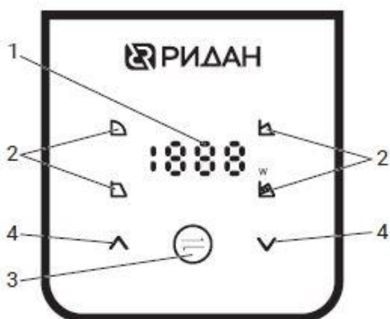
Рис. 5. Панель управления насосом RWE 40...80-XXX.
