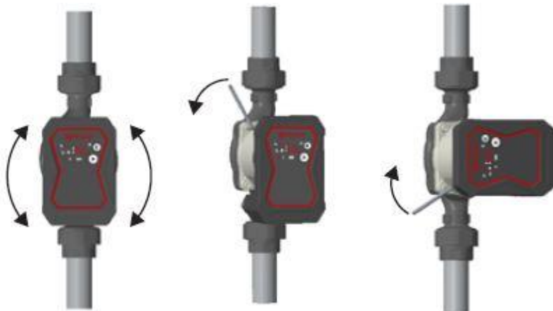
Рис. 7. Изменение положения блока управления.
