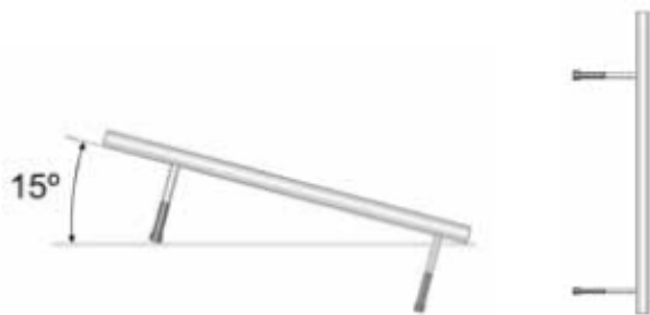
Монтаж теплообменников микроканальных типа MCHE
