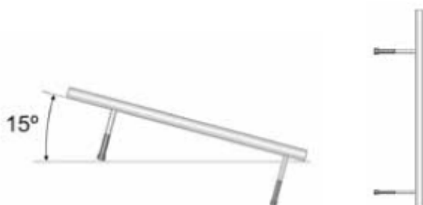
Монтаж теплообменников микроканальных типа МСНЕ
