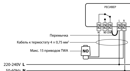
Подключение с использованием 4-х жильного кабеля
