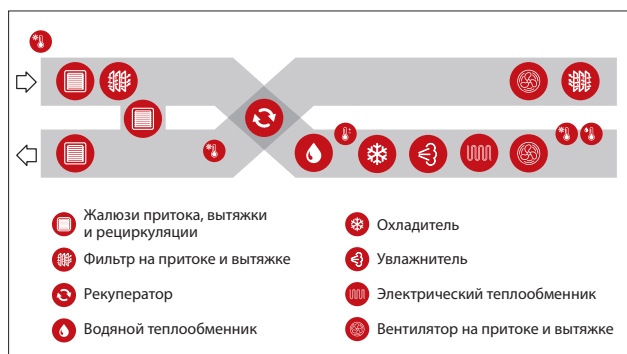
Рис. 51. Оборудование, которое входит в комплекс приточно-вытяжной вентиляции
