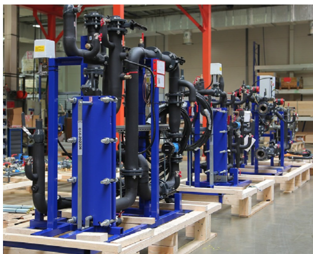
Рис. 39. БТП «Ридан» с пластинчатыми теплообменниками
