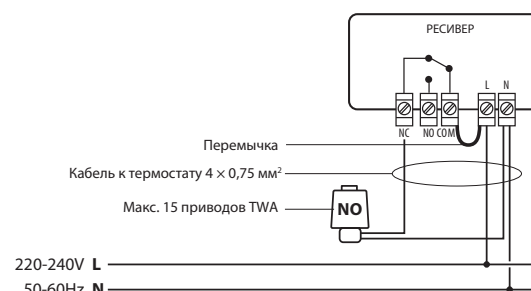
Подключение с использованием 4-х жильного кабеля
