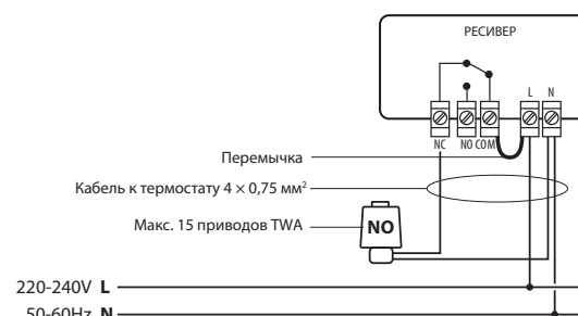
Подключение с использованием 4-х жильного кабеля
