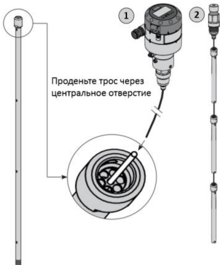
Рис. 5 Регулировка измерительной части
