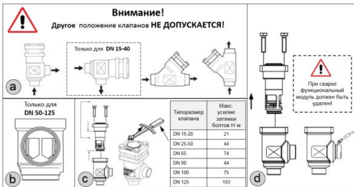
Рис. 4 Инструкция по установке
