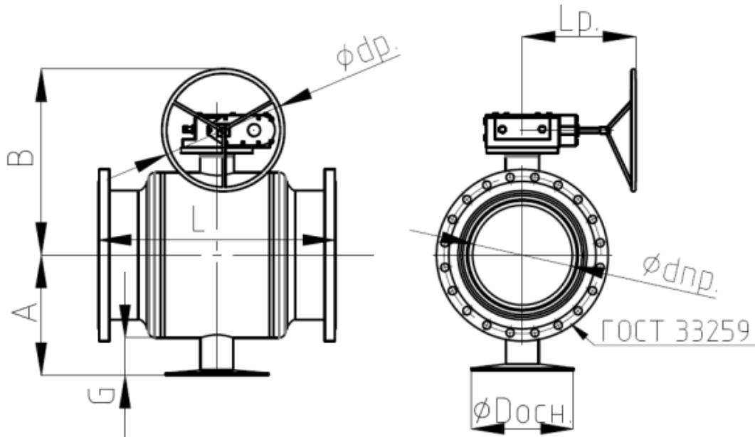
Габаритные и присоединительные размеры кранов шаровых типа РЛР в мм.
