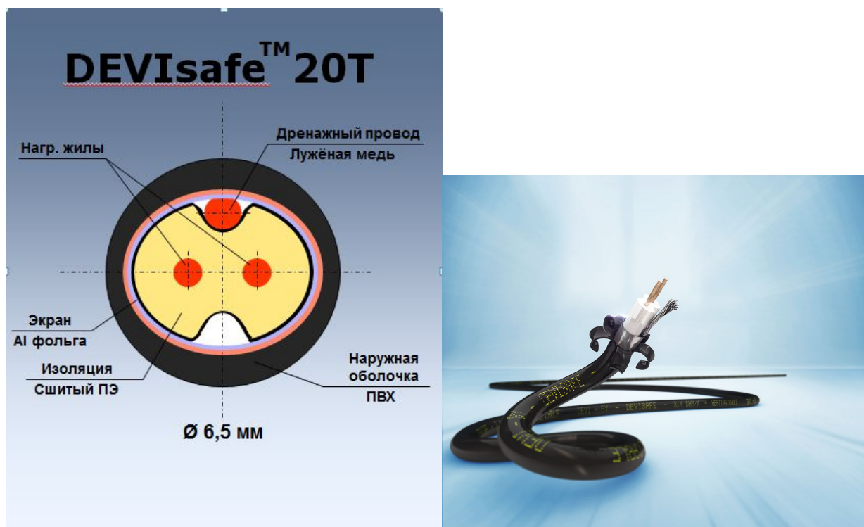
Рис. 2. Устройство нагревательного кабеля DEVIsafe™ 20T .
