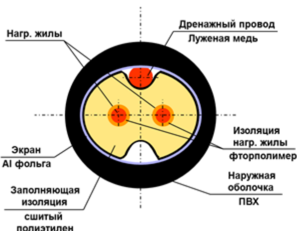
Рис. 2. Устройство нагревательного кабеля ДЕВИ Snow-30Т
