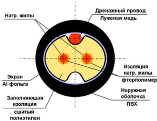
Рис. 2. Устройство нагревательного кабеля DEVIsnow™ 30T.
