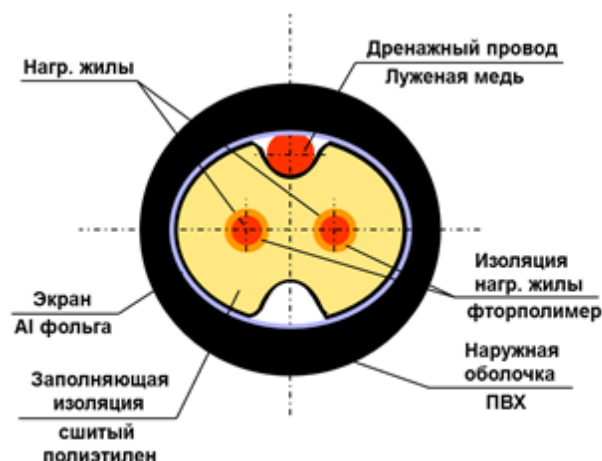
Рис. 2. Устройство нагревательного кабеля ДЕВИ Snow-30Т
