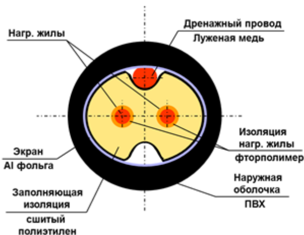
Рис. 2. Устройство нагревательного кабеля DEVIsnow™ 30T.
